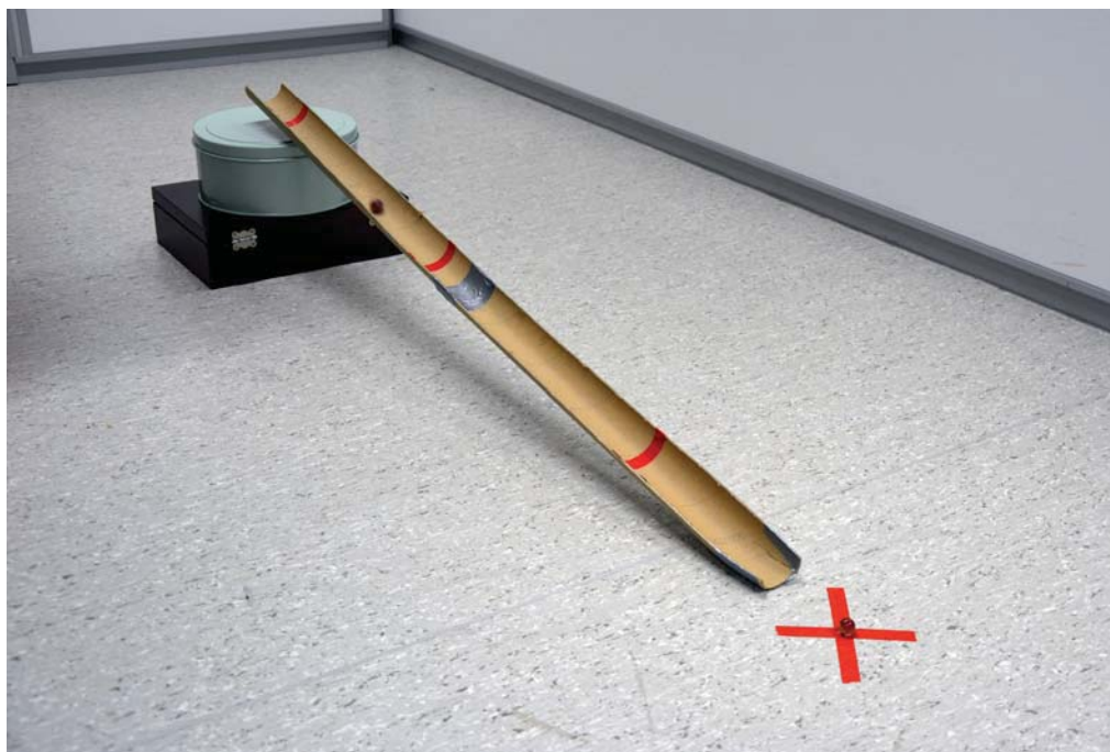
Een rolgoot om knikkers steeds met dezelfde snelheid te laten rollen
